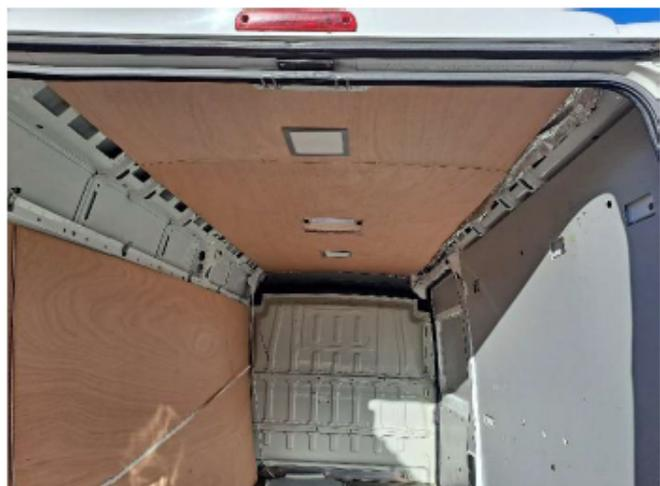
Démarrage du doublage intérieur et installation de l'éclairage au plafond
